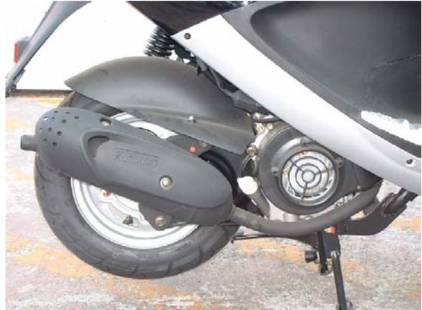
Locking torque: M6: 0.7-1.1kg.m
